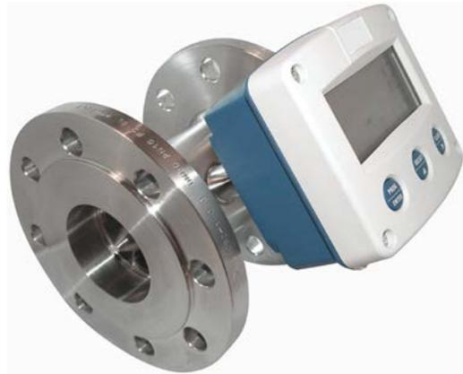
Il misuratore di portata a turbina, è costituito da un gruppo rotore con il relativo albero è montato su cuscinetti a sfera all'interno dell'assieme, e viene messo in rotazione dall'energia cinetica del Gas che scorre ad una velocità angolare che, nell'intervallo lineare del misuratore di portata, è proporzionale alla velocità assiale media del Gas. Le pale del rotore spazzano via l'alesaggio totale del misuratore di portata ad eccezione di uno spazio piccolo spazio libero.
